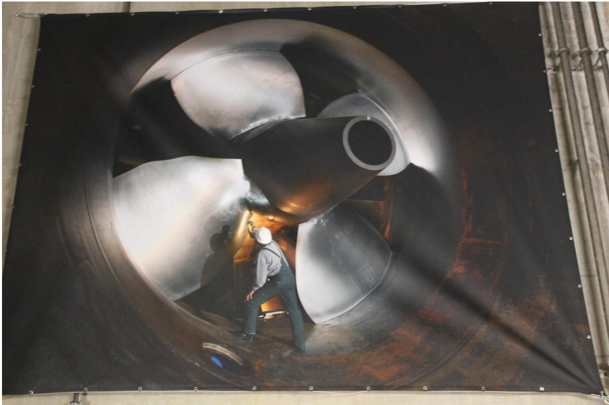
Turbine in der Revision
